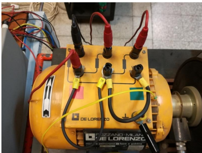
Slika 61. Povezivanje asinhronog motora spregnutog u zvijezdu
