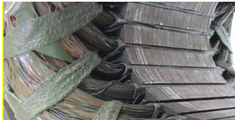
Slika 28. Izgled statora trofazne asinhronne mašine
